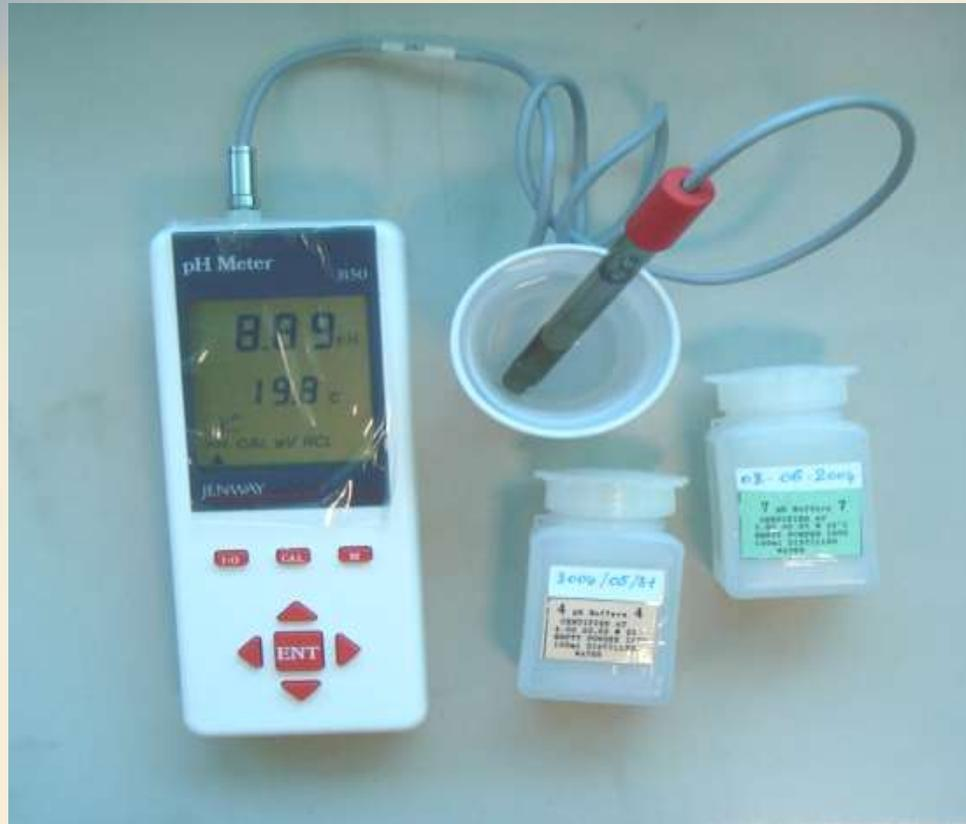
**Un Ph-mètre est constitué d'une sonde reliée à un voltamètre. Il permet de mesurer le degré d'acidité ou d'alcalinité d'une solution aqueuse.**
